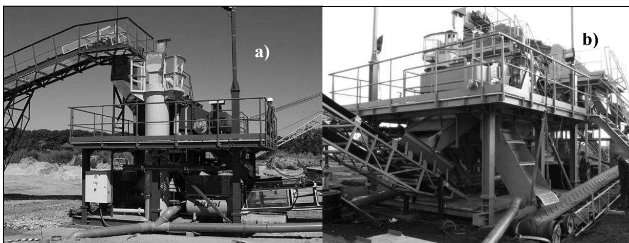
Rys. 4. Klasyfikator K-100 w Januszkowicach (a) oraz w Zdziechowicach (b) [5] Fig. 4. K-100 pulsatory jig near Januszkowice (a) and Zdziechowice (b) [5]
